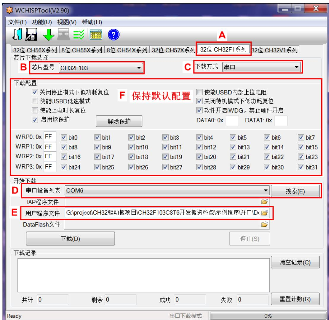
5、进行程序下载前，需要点击解除保护按钮，待出现**解除读写保护成功**的提示后，才能进行程序下载，如下图所示：
