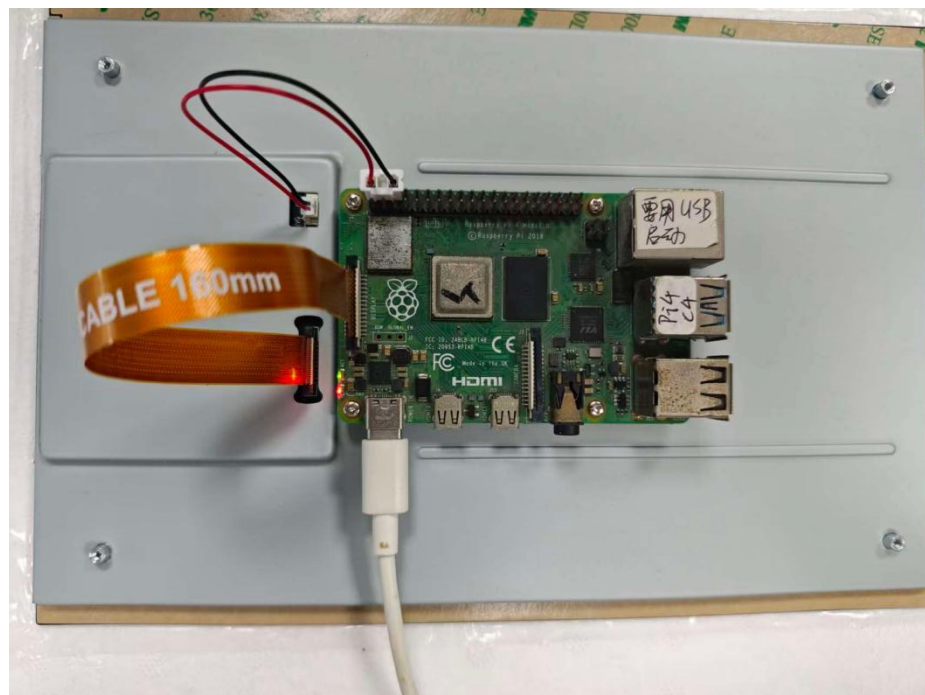
连接树莓派电源线
