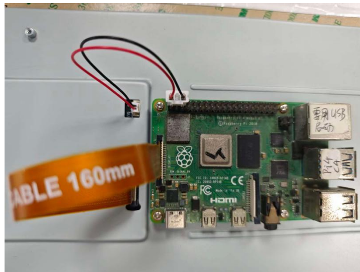
连接 5V 电源连接线
