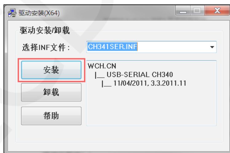
图 2 CH340C 驱动安装
