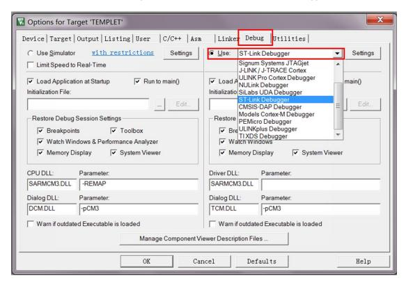
6、将 STM32F103C8T6 最小系统板上电,然后点击 Use 旁边的 Settings 按钮,弹出如下界面,则说明 ST-LINK 下载器连接成功:
