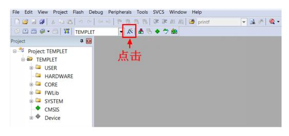
5、在弹出的界面里点击 Debug 按钮,然后在 Use 里选择 ST-LINK Debugger,如下图所示:
