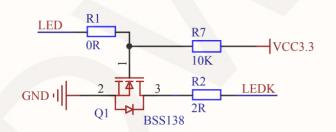
**背光控制电路(可IO或者PWM控制)** LED不接或者接高电平,背光常亮 LED不接或者接低电平,背光熄灭
