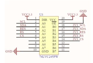
5V转3.3V电平转换电路
